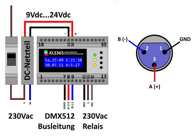
Der Anschluss der einzelnen Lampen an das KSL365 gestaltet sich dank des verwendeten Bussystems sehr einfach:
