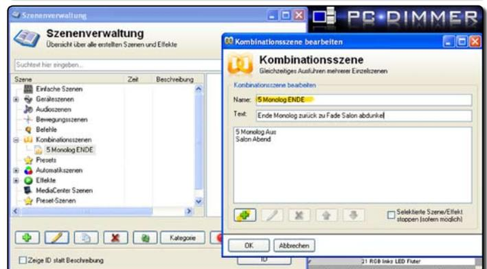
Test; Abspielen von «Salon Normallicht», «Salon Abend», nach kurzer Pause «5 Monolog EIN» nach kurzer Pause Kombinationsszene «5 Monolog Ende». Verfolgen sie die Fader auf der Faderbank. Wenn alles richtig ist, geht Kanal 7 auf Normallicht, danach beginnt der langsame Fade, danach auf 100%, danach auf 45% und sinkt mit der Restfadezeit von Salon Abend auf 42%.
